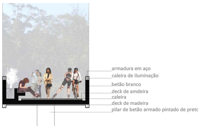
Fig. 03 24 – Perfil da Ponte. Fonte: IA.
